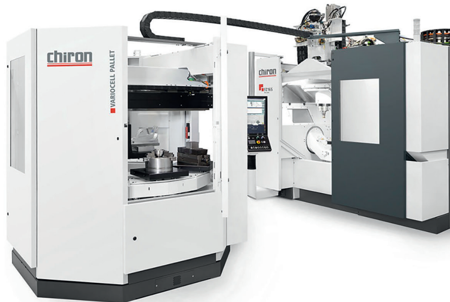
1 Komplexe Werkstücke autonom bearbeiten – zur EMO kombiniert Chiron die neue FZ 16 S five axis erstmals mit der Palettenautomation VariocellPallet (© Chiron Gruppe)
